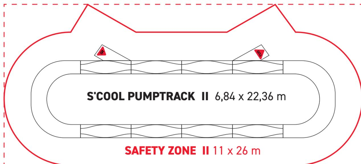
Der Pumptrack besteht aus 2 Steilkurven, jeweils 4 Wellen, einer Ein- und Ausfahrt. Optional ist er mit 3 oder 4 Wellen aufbaubar. Ein verkürzter Aufbau auf jeweils 3 Wellen pro Seite verändert jedoch das Fahrverhalten und ggf. wird dadurch der Fun-Faktor minimal abgeschwächt.
